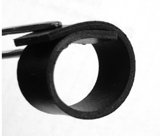
6. ábra: Erősített Rec 2 próbatest feltekereselve
