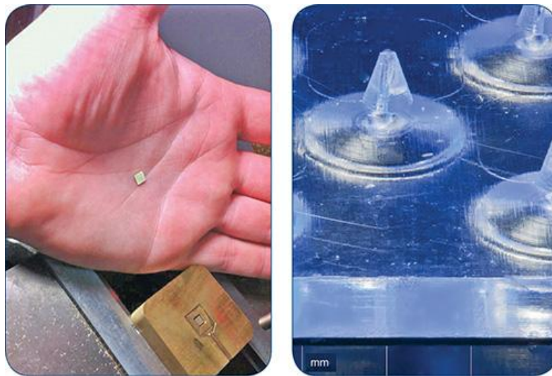
2. ábra Balra: fröccsszerszámbetét és fröccsdarab (bőrre alkalmazható mikrotapas, amely gyógyszerek adagolására alkalmas). Jobbra: a termék erősen kinagyított képe több vékony tűt mutat (<1 mm). Készülhet LCP, PC, PMMA és COC polimerből
