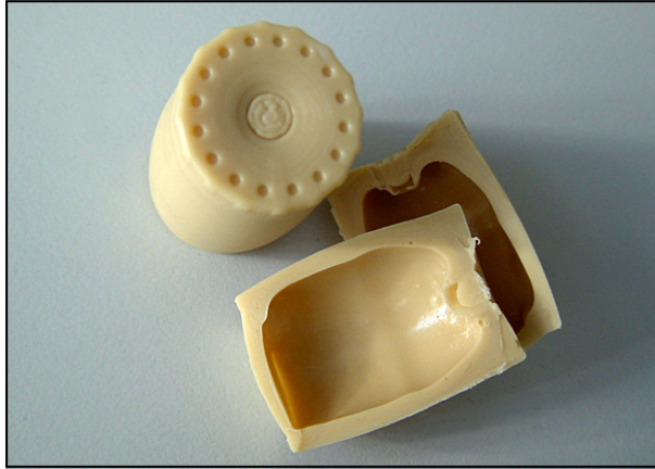
4. ábra GaNaSys eljárással gyártott dugók
