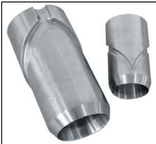
1. ábra A szívhajlatba belépő (baloldalt) és a szívhajlatot elhagyó (jobbaldalt) ömledék áramlása
