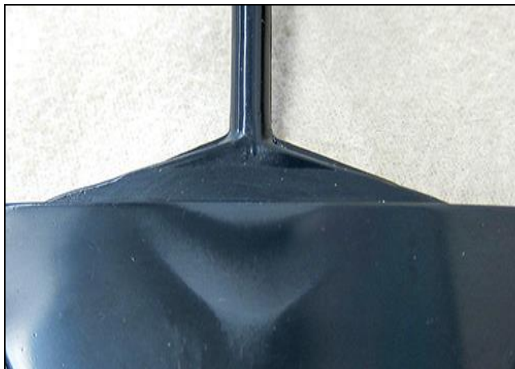
2. ábra Legyezőbeömlő okozta elszíneződés (kifehéredés) PC/ABS fröccsdarabon. Ok: a gát vastagsága csak 40%-a volt a darabénak, a helyes méret a 80% lenne
