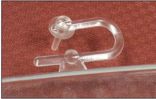
3. ábra Az indirekt ékbeömlő hideg anyag túlfolyóval kitűnő terméket ad a nyírési anomáliák kiküszöbölésével PMMA, PC, PC/ABS és PC/PBT anyagok esetében
