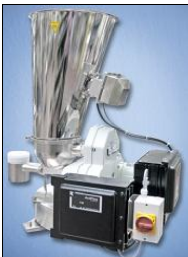
3. ábra A K-Tron (Schweiz) AG ActiFlow vibrátorral összeépített adagolótölcsére
