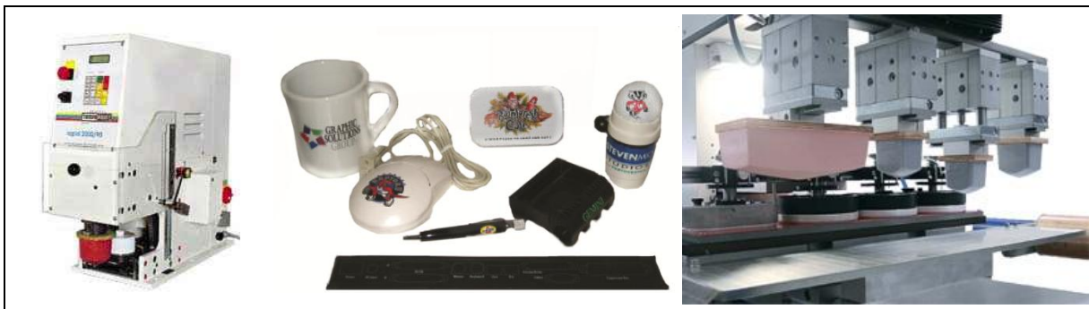
2.5.1. ábra Egy és négy szín nyomására alkalmas tamponnyomó gépek és néhány ezekkel készült grafika a termékeken
