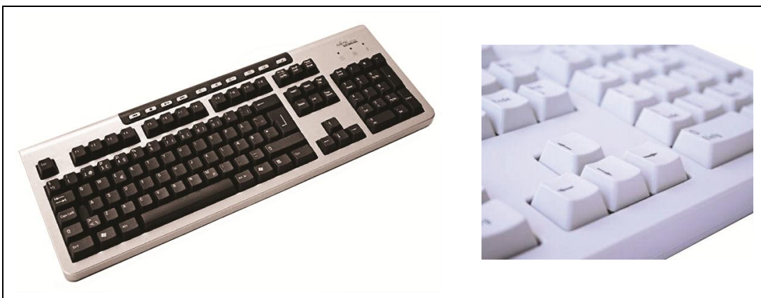
2.5.3 ábra Lézeres feliratozással készült fekete és fehér alapú számítógép-klaviatúra
