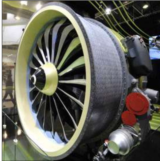
2. ábra A kísérleti Leap repülőgépmotor szén-szálalás epoxigyantából készített ventilátora a titánélű lapátokkal
