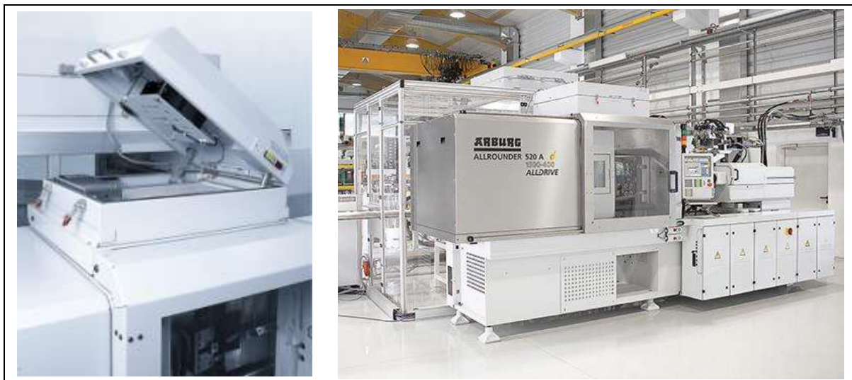
1. ábra Egy Allrounder típusú fröccsöntő gép szerszámfelfogó lapjai fölé épített tisztatéri modul ionizátort és szűrőket tartalmazó felső része (bal oldali kép) és a teljes modul elhelyezkedése a fröccsgépen, mögötte a kiegészítő műveleteket elvégzésére szolgáló, ugyancsak tisztatérű kamra (jobb oldali kép)
