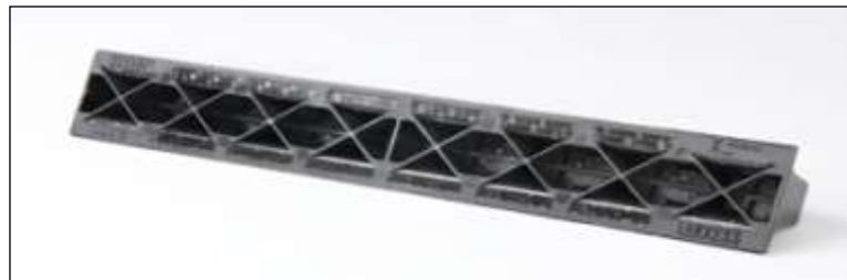
1. ábra Vékony bordákkal erősített, 55%üvegszálat tartalmazó PA6 kompaundból gyártott félkész termék
