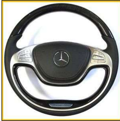
3. ábra Önjavító karcállóságú PUR bevonattal ellátott Mercedes S modell kormánykereke
