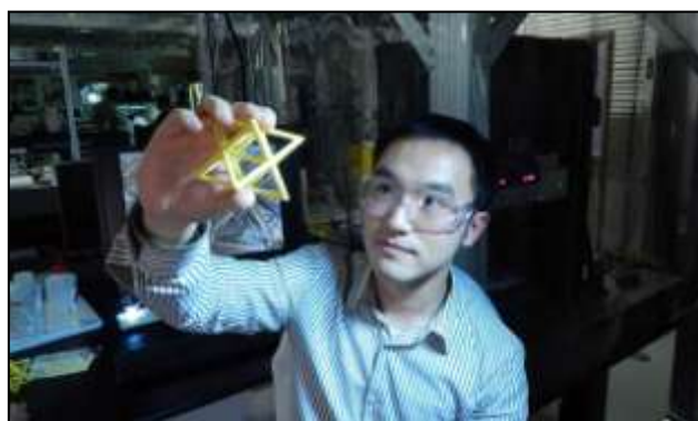
2. ábra Az ultrakönnnyű anyag szerkezetének modellje
