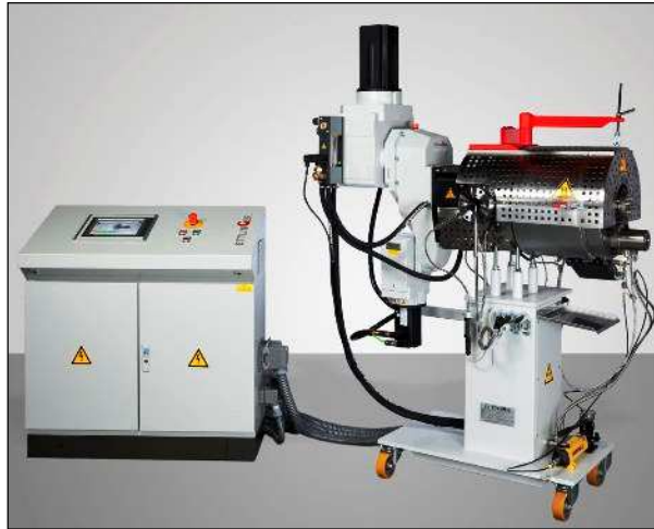
4. ábra A kerekeken guruló Eco-Filter a vezérlőszekrénnel
