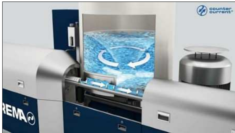
3. ábra Az Intarema eljárásban a vágó/tömörítő elem az anyag extruderben követett haladási irányával ellentétes irányban hordja be a feldolgozandó hulladékot
