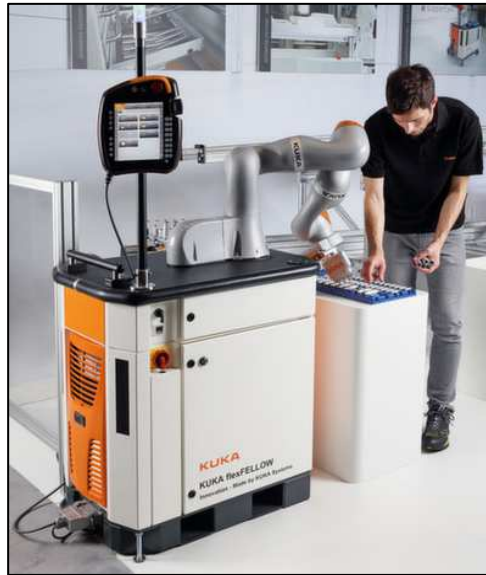
5. ábra A mobil Plattform flexFellow bárhol felállítható és átmeneti automatizálásra alkalmazható
