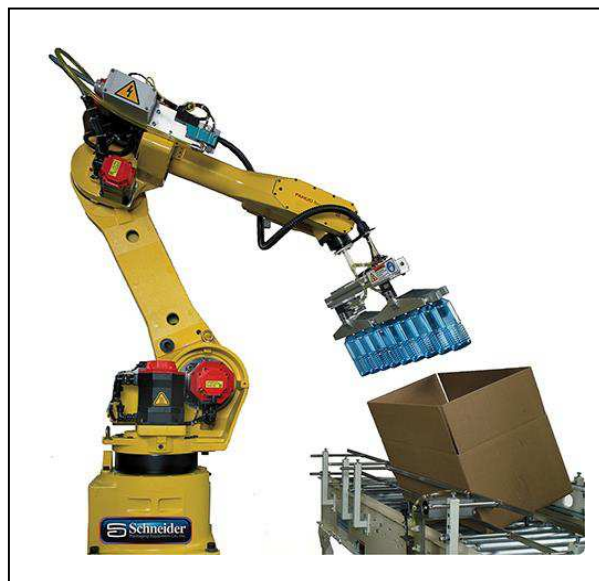
1. ábra A robot egy palackcsoportot emel be a raklapon szállítható papírkonténerbe
