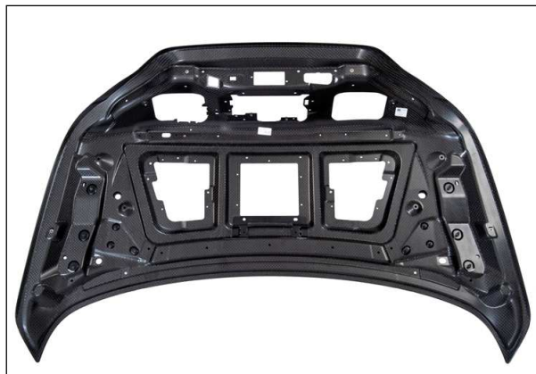
1. ábra Szénszál-erősítésű műanyag csomagtartókeret a Dieffenbachertől
