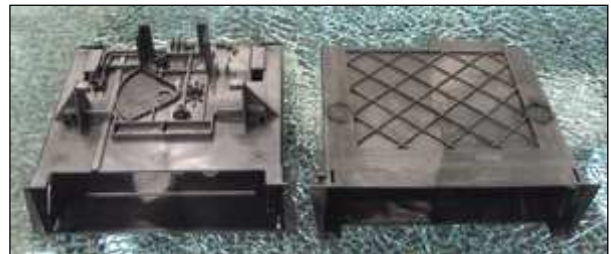
5. ábra Az Arburg cég a 2015-ös Fakuma kiállításon egy szinematikus rendszer dobozát fröccsöntötte Profoam technológiával
