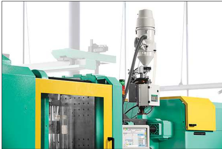
3. ábra A kétkamrás zsilip a fröccsgépre szerelve
