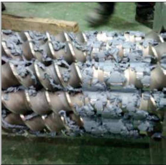
4. ábra A RingExtruder ER -ben 12 csiga forog azonos irányban egy körgyűrű mentén
