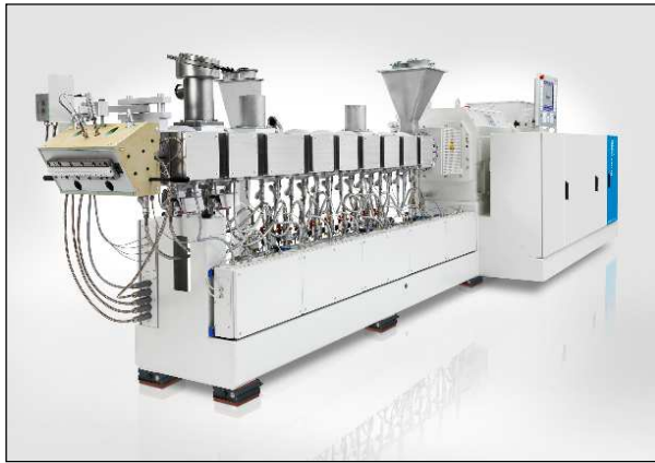
1. ábra A KraussMaffei Berstorff cég kétcsigás ZE Blue Power kompaundáló extrudere
