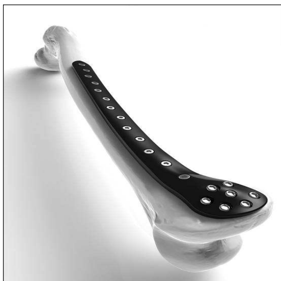
4. ábra Szénszálas PEEK-Optima Ultra reinforced támasztóelem egy combcsonton vizsgálatra előkészítve
