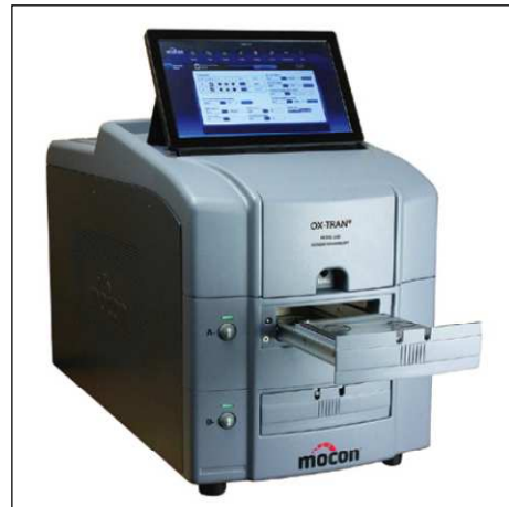
6. ábra A Mocon Inc. oxigénáthatolási sebességet mérő Ox-Tran 2/22 L típusú készüléke
