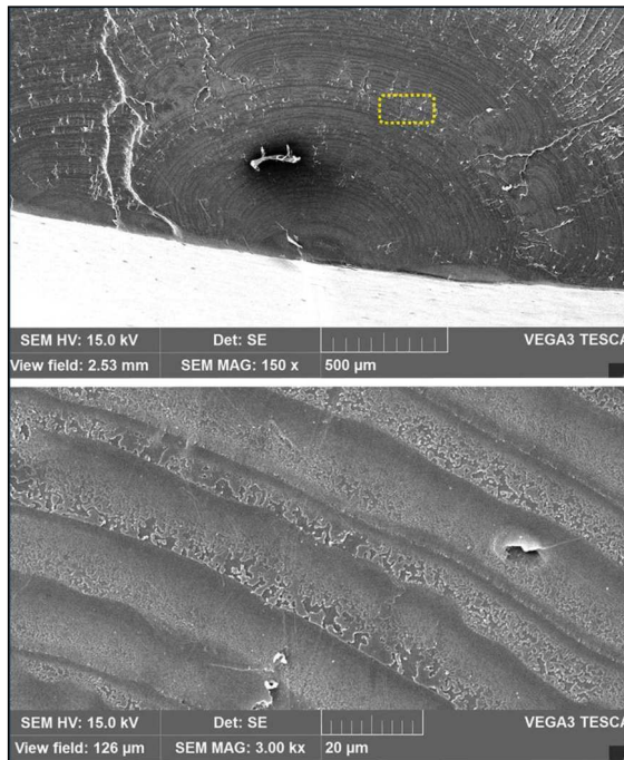
3. ábra Egy ESC törésfelület pásztázó elektronmikroszkóppal felvett képe.
